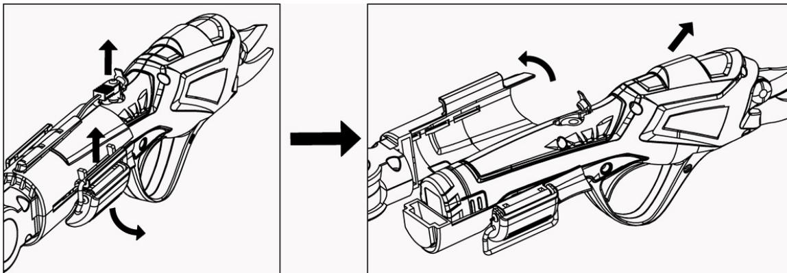
**Fonction d'assemblage de la tête pivotante**
