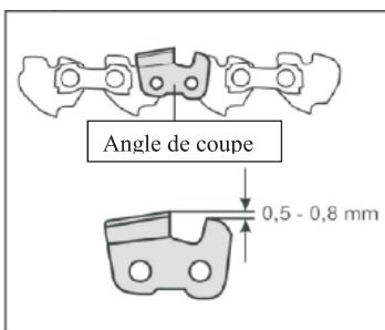
Une distance limite de profondeur trop grande représente un risque de rebond. A cet effet, vous devez vérifier la distance conformément aux spécifications de votre chaîne et la limer avec une lime si nécessaire.
