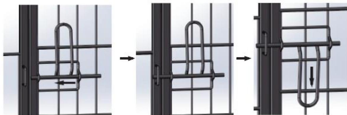
4) Fermez la porte en faisant coulisser la barre de la poignée dans le trou de la fermeture.
