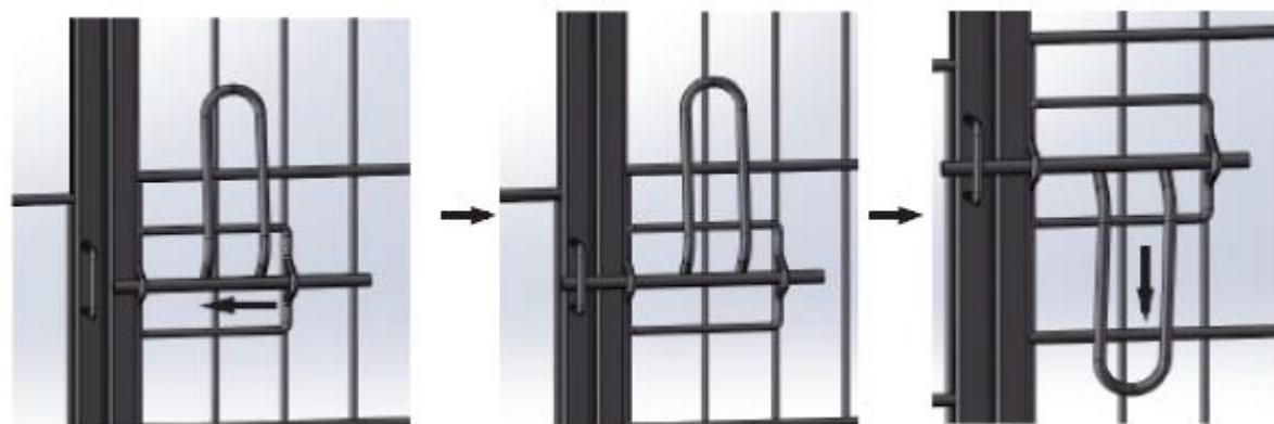
4) Sluit de deur door de krukstang door het gat in het slot te schuiven.
