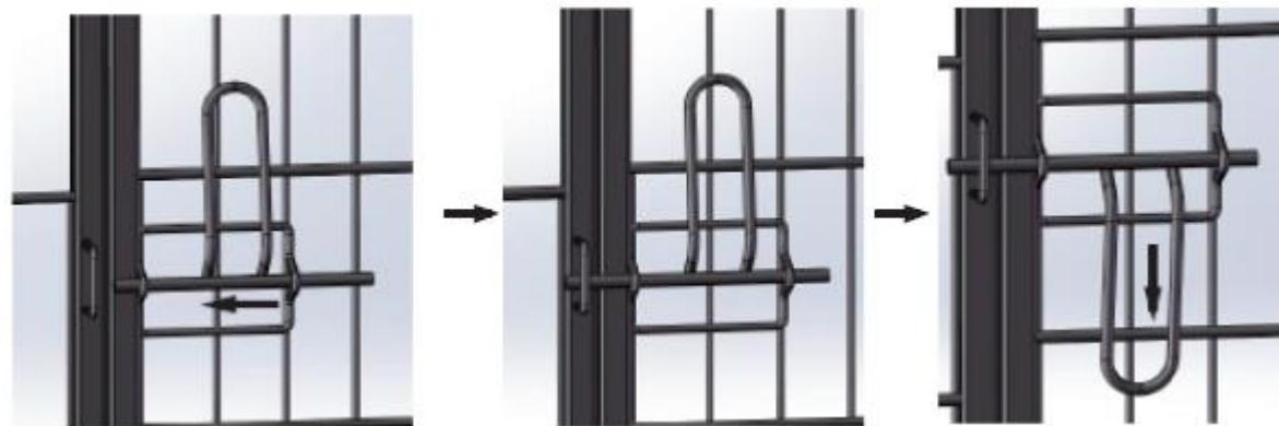
4) Schließen Sie die Tür, indem Sie die Griffstange in das Loch des Verschlusses schieben.
