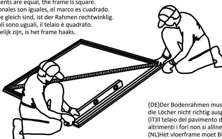
**(FR)Le cadre de plancher doit être à la fois d'équerre et de niveau, sinon les trous ne seront pas alignés correctement.**
