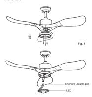
Colocar de nuevo la cubierta y la pantalla de la lámpara.
