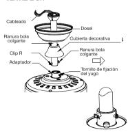
Si se desea extender la longitud colgante del ventilador hay que retirar la bola colgante de la varilla de 15cm., provista para usar con una varilla extendida (incluída).
