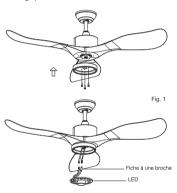
Remettre la protection et la plaque sur le ruban LED.
