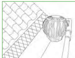
Les 2 pièces. Adaptable sur les descentes de gouttière rondes, carrées ou rectangulaires Ø 60 à 100 mm. Dim. sphère Ø 13 cm. En PVC. Permet d'éviter les débordements en facilitant l'écoulement.
